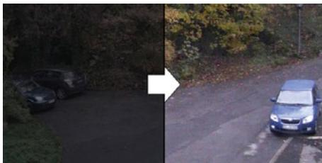
Die dynamische Verstärkungsregelung (auch Gain Control genannt) ist ein elektronischer Schaltkreis, den man gewöhnlich in Kameras vorfindet, die das Videosignal bei schwachen Lichtverhältnissen verstärken. Bei normalem Betrieb sorgt sie für einen konstanten Verstärkungsfaktor.
